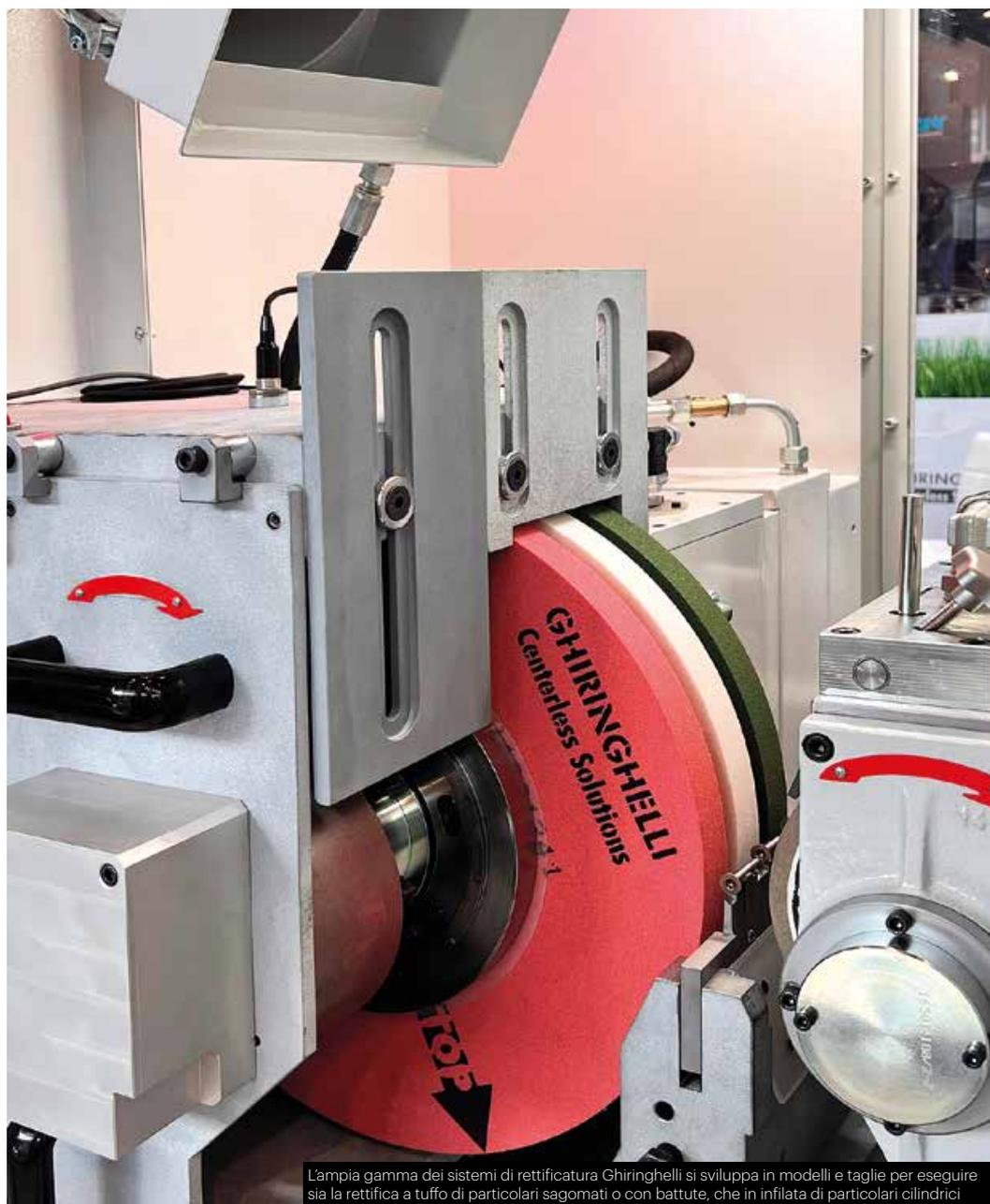
L'ampia gamma dei sistemi di rettificazione Ghiringhelli si sviluppa in modelli e taglie per eseguire sia la rettifica a tuffo di particolari sagomati o con battute, che in infilata di particolari cilindrici
