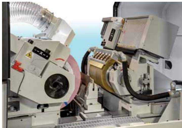
La testa portamola operatrice è capace di montare mole con diametro di 610x400 mm di fascia, potenza 51 kW e velocità periferica costante fino a 63 m/s
