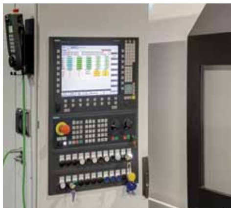
Sopra: il CNC Siemens 840D Solution Line integra l'esclusiva piattaforma software di proprietà Ghiringhelli
