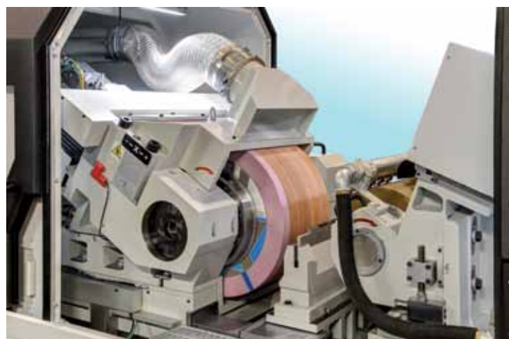
La testa portamola operatrice è capace di montare mole con diametro di 610x400 mm di fascia, potenza 51 kW e velocità periferica costante fino a 63 m/s
