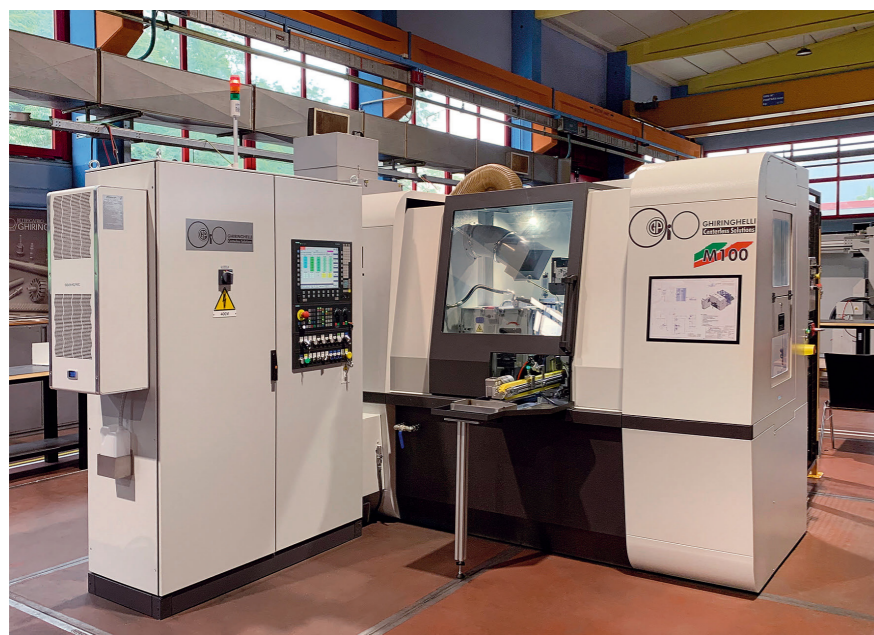
1 Aus der breiten Palette an spitzenlosen Rundschleifmaschinen der Ausführung M100 von Ghiringhelli lassen sich vielfältige technologische Lösungen für das hochgenaue Einstechschleifen gestalten © Ghiringhelli
