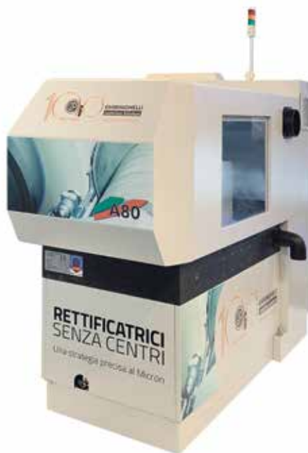
La macchina integra tutto il necessario nel suo layout molto compatto e poggia su un basamento costituito da un monoblocco in granito naturale
