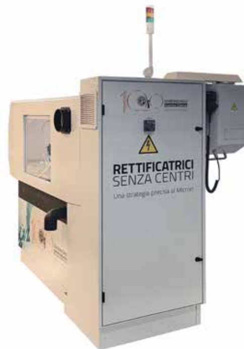
L'armadio di potenza è disposto su un lato della macchina, divenendo parte integrante della stessa
