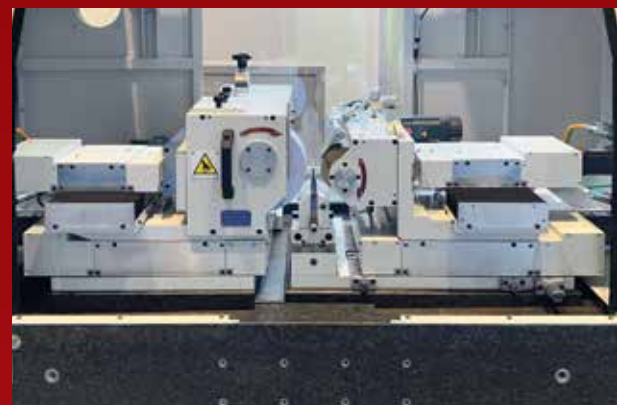
La ravvivatura della mola operatrice (assi X/Y) e della mola conduttrice (assi X1/Y1) è gestita da CNC con gruppi ortogonali di diamantatura ad assi interpolati
